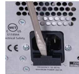
Extracción de portador de fusibles
